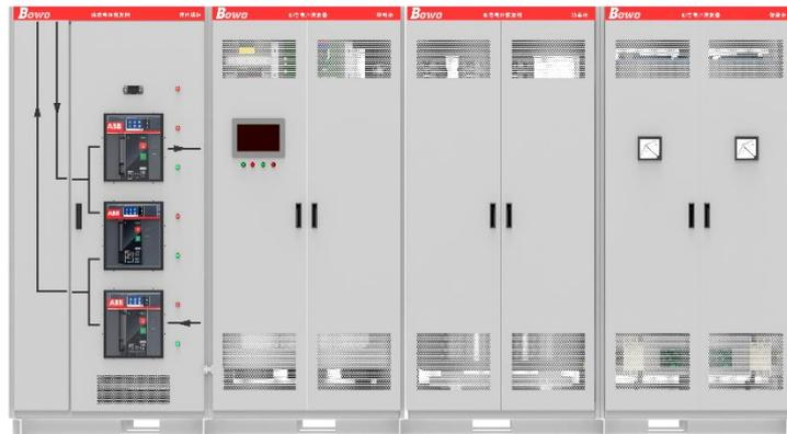
BW-DVR 系列动态电压恢复器是带有储能装置（系统）的补偿装置，其主要功能是有有效防止暂态电能质量问题（电压暂降、电压骤升、供电短时中断等）对负载的影响，适用保护整条生产线的正常工作，可串联在系统供电线路和负荷之间（注：功率回路并联到负载前端）。
